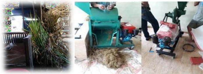
Gambar 4. Proses Pencacahan Rumput/Jerami dalam Meningkatkan Palatabilitas Ternak
