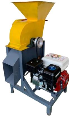
Gambar 2. Mesin Pencacah Rumput (Silase)
