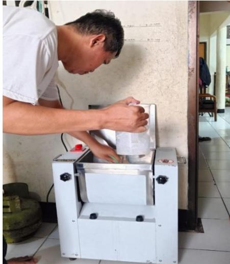
Gambar 4.4 Percobaan Penggunaan Mesin Pengadon Pempek
