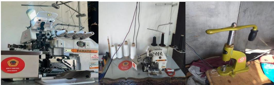
Gambar: Mesin Obras dan Mesin Kancing
