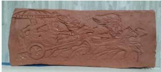
**Gambar 2. Pola master cetakan relief sangkar**
