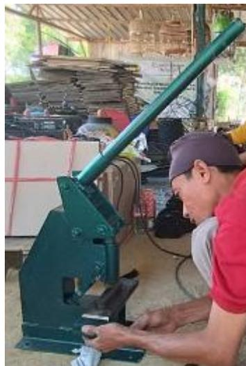
**Gambar 6. Mesin plong besi plat penyambung sangkar**
